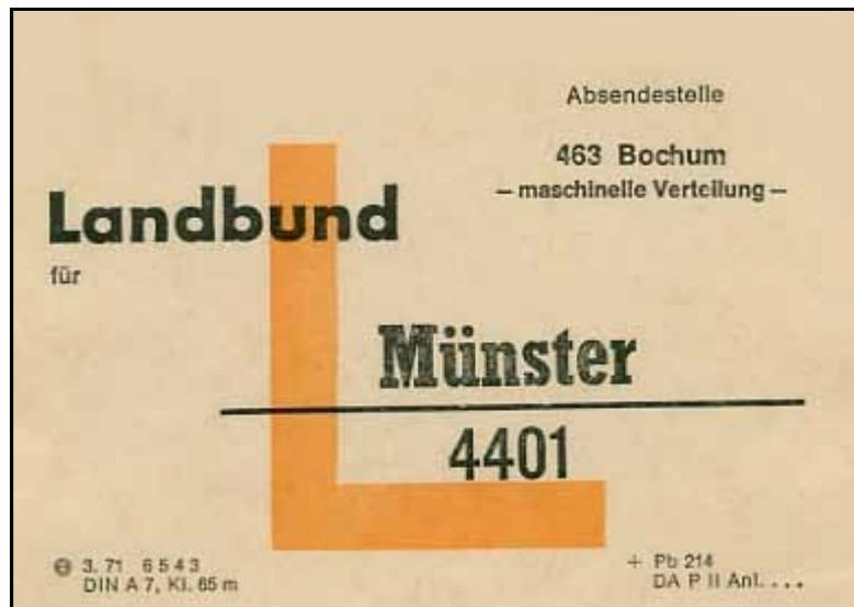
Die aus den Verteilfächern der Briefverteilmachines entnommenen Briefbündel werden mit einem sogenannten Vorbindezettel versehen und verschnürt, bevor sie ihrer Beförderungsstrecke zugeleitet werden. Oben ein Vorbindezettel mit Aufdruck "maschinelle Verteilung" für das Abgangsprogramm nach Münster.
